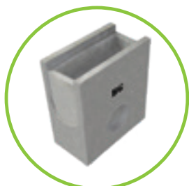
Sinkkasten für BG Standardrinnen L=500 mm, passend zur NW mit vorgeformten Auslauf
