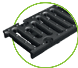
Gussrost SW 16/120 bzw. 16/220, KI. F – 4-fach verschraubbar , für NW 100 und 200
