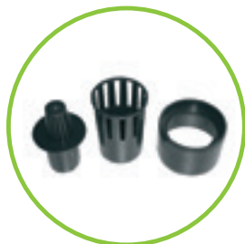
Geruchverschluss für Bodenablauf bestehend aus 3 Teilen – einsetzbar bei Rinnen mit Ablaufbohrung DN 100 – nicht zum Nachrüsten
