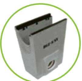
Sinkkasten für BGZ-S Schwerlastrinnen, L=500 mm, passend zur NW mit RDS 150 oder 200
