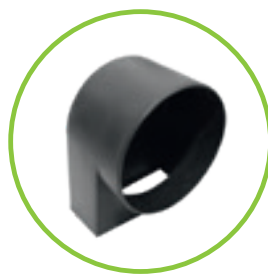
Geruchverschluss für Sinkkästen zum Nachrüsten DN 100/150 Einbau: Den Geruchverschluss innen im Sinkkasten einsetzen und mit dem Kanalrohr von außen zusammenstecken.
