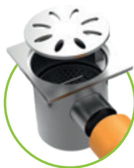
omega Ablaufelemente inkl. Geruchsverschluss und Schlammeimer, horizontaler Ablauf
